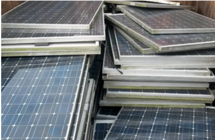
Abbildung 29 Nicht mehr gebrauchsfähige PV-Module.
