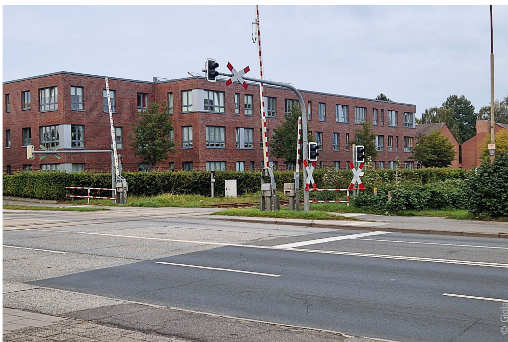
Abb. 4: Wohngebäude in unmittelbarer Nähe von Straßen und Schienenverkehrswegen benötigen wirkungsvolle passive Schutzmaßnahmen. Hier wurden weniger schutzbedürftige Räume und geschlossene Wintergärten in Richtung der Straßenverkehrsemissionen angeordnet. Zum Schutz gegen Emissionen aus dem Schienenverkehr ist es empfehlenswert, die Fundamente und Kelleraußenwände gegen Schwingungsübertragung zu isolieren.
