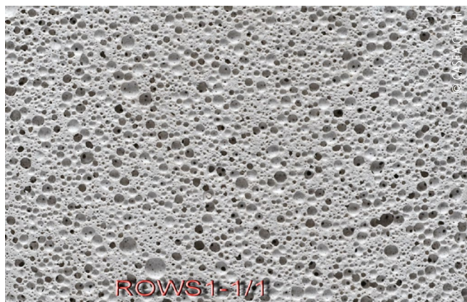
Abb. 1: Porenstruktur des entwickelten Schaumgipses
