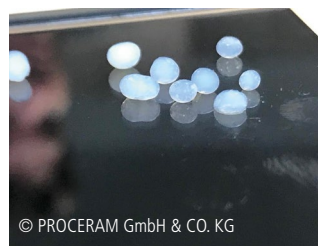
Abb. 15: Kontinuierlich hergestellte Aerogel-Kugeln für die Anwendung in Aerogeldämmputzen
