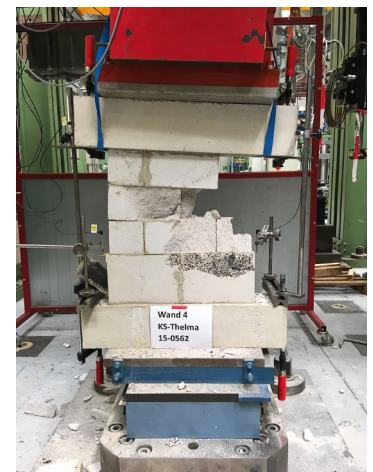
Abb. 11: Schematischer Aufbau des Prüfkörpers für die Mauerwerksdruckfestigkeit (links) und Versagensbild des Kalksandsteins nach Abschluss der Prüfung (rechts)
