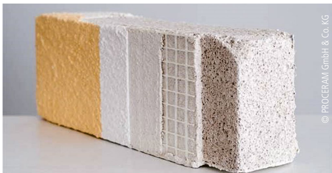
Abb. 16: Schichtaufbau des entwickelten Aerogel-Dämmsystems
