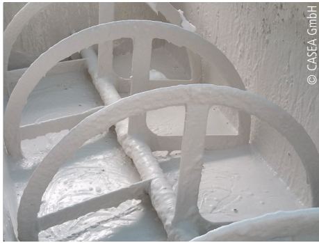
Abb. 3: Frisch angemischter Gips-schaummörtel in der speziell entwickelten Mischkammer
