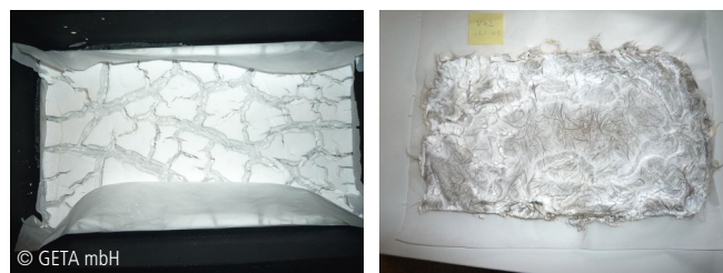
Abb. 13: Bild der unbewehrten Aerogelplatte nach der Trocknung (links) und der bewehrten Platte (rechts)
