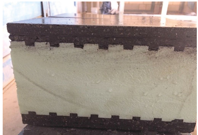
Abb. 7: Schnitt durch ein Sandwichelement
