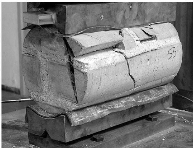
Abb. 7: Prüfkörper nach dem Bruch (als Zwischenlage Bleiplatten) ([10], S. 951)
