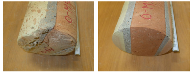
Abb. 5: Mauerwerksoberfläche vor und nach dem Zuschneiden
