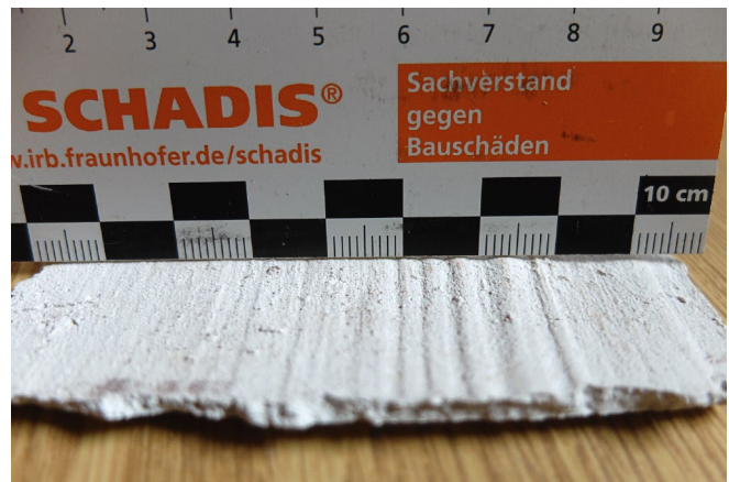
Abb. 6: Abdruck von Unebenheiten des Bohrkerns auf einem Stück des Abgleichgipses (eigene Versuche J. Henkel)
