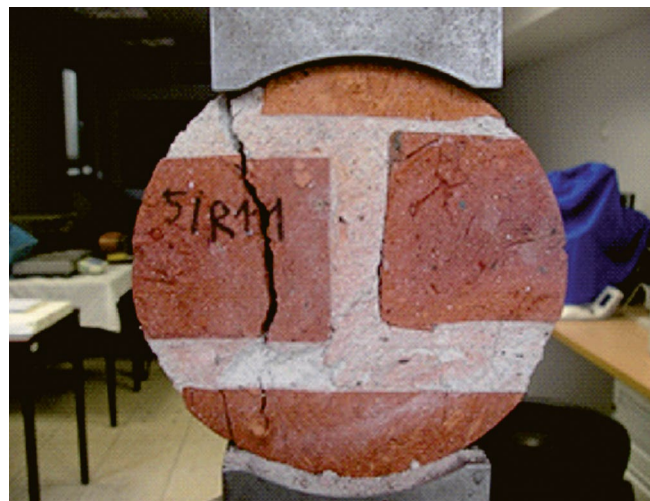
Abb. 8: Prüfkörper nach dem Bruch ohne Zwischenlage ([11], S. 95)
