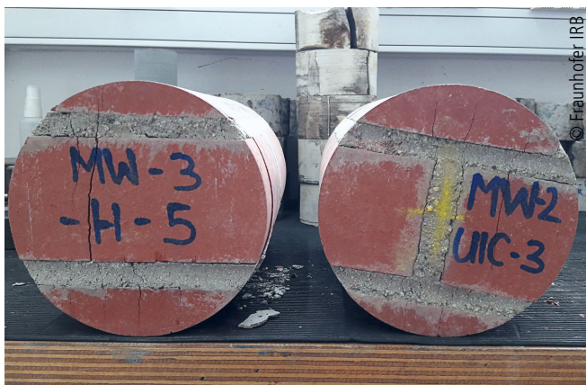
Abb. 10: Versuchskörper von WEYDERT [15] mit den Fugenbildern 1 (links) und 2 (rechts)
