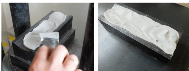
Abb. 6: Aufbringen der Gipsauflage auf die untere und die obere Prüfkalotte
