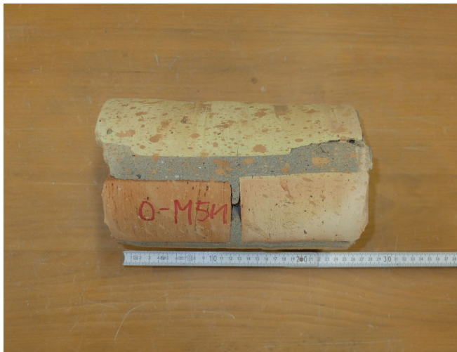
Abb. 4: Bohrkern zum Fugenbild 1
