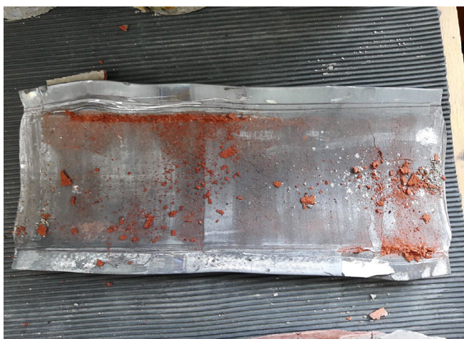
Abb. 12: Bleizwischenlage nach dem Druckversuch
