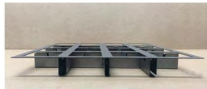
Abb. 7: Prototyp eines nachhaltigen Gitterpaneels (GreenGrid) und der Zellen. Adapt Lab Faul, an der Architektur-fakultät der Universität Lissabon <http://adapt.fa.ulisboa.pt>
