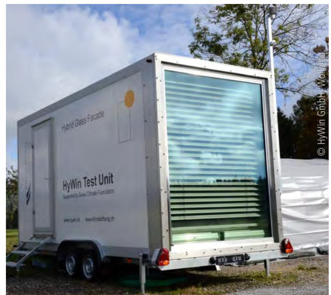
Abb. 11: Die experimentelle Testeinheit mit HyWin Element
